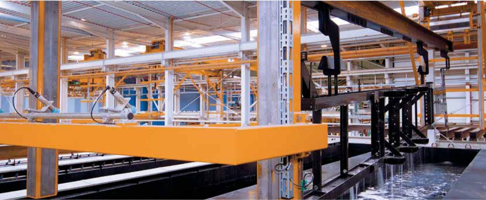
Ergänzt wird das umfangreiche Produktportfolio der **hebro®chemie** durch Erzeugnisse für die Passivierung. In der Oberflächentechnik ist damit gezielte Erzeugung einer nichtmetallischen Schutzschicht auf einem metallischen Werkstoff gemeint, um die Sauerstoffkorrosion des Grundwerkstoffes zu verhindern oder stark zu verlangsamen.
