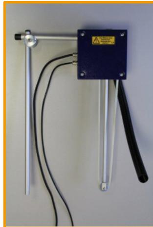
Der **Ölskimmer R35** wird zur vollautomatischen, zeitgesteuerten und kontinuierlichen Pflege von wassermischbaren Kühlschmierstoffen verwendet z.B. an Zerspanungsmaschinen oder Späneförderern.
